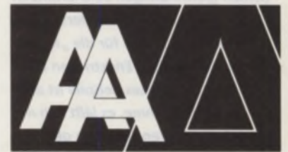
Einzüge an den „Ballungszentren“ eines Zeichens sind für einen ausgewogenen Grauwert im Satz von Bedeutung (im Beispiel zu sehen im oberen Teil der Punze des vorderen „A“). Das Zeichen hätte sonst an dieser Stelle einen zu hohen Schwärzungsgrad.
