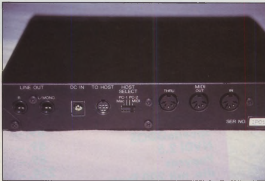
Die Rückseite mit den Anschlußmöglichkeiten des TG-100
