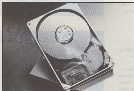
Die Maxtor-3,5"-Festplatte verfügt über 345 MB Speicherkapazität.
