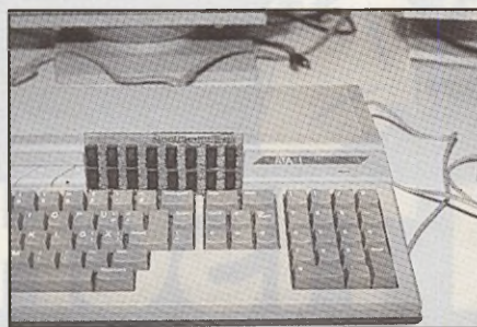
Die 14MB-Speichererweiterungskarte für den Falcon vom Layout Service Kiel
