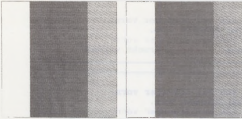
Grafikprobe des Fujitsu DL 1100 und des STAR LC 24-200 Colour (360 x 180 dpi, unidirektional gedruckt).
