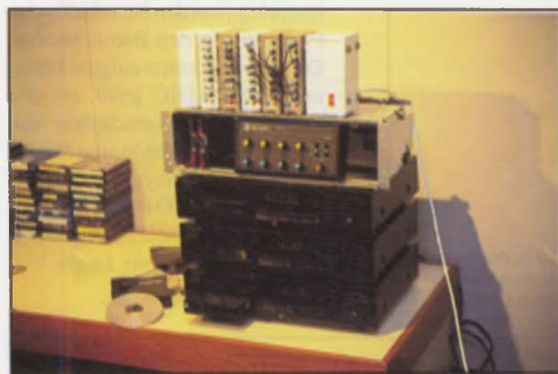
Der CD-Block mit Steuer-Hardware in der Prototypversion. Oben das Interface und die I/O-Module mit den Steuereinschüben und der Mischeinheit.
